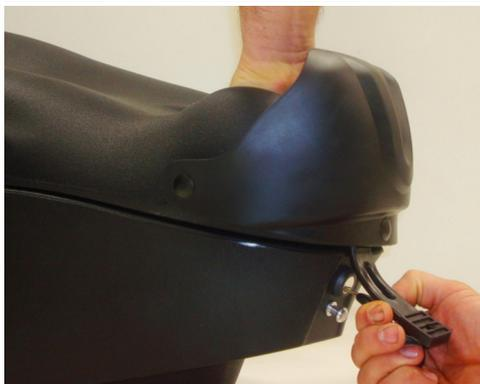
**Pour bien verrouiller le coffre :** Pousser sur le couvercle en même temps que vous tourner la clé vers la droite, retirer la clé. (Voir photo) **To properly lock the cargo box:** Push on the cover while turning key to the right, then remove key. (See photo)
